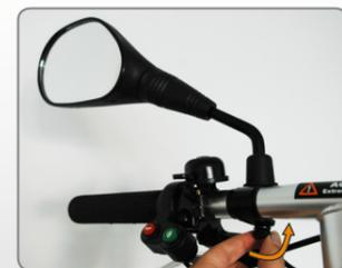
Drehe die Schraubmutter und die Unterlegscheibe vom Rückspiegel ab. Biege die Haltespange auf. Umschließe mit der Spange die mit einem Gewebekband geschützte Stelle am Lenker. Bringe den Spiegel in eine aufrechte Position und schraube ihn mit dem beiliegenden Werkzeug fest.
