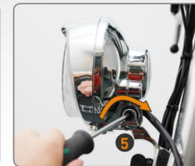
1 Nehme das Frontlicht aus der unteren Halterung (zerschneide ggf. den weißen Kabelbinder) und 2 stecke es vorsichtig in die obere Halterung, so dass die Kabel umschlossen werden. 3 Drehe den Schnellverschluss im Uhrzeigersinn bis dieser leicht fest ist, 4 klappe ihn dann um. Richte die Frontleuchte in Fahrtrichtung aus, 5 löse hierzu die seitliche Schraube.
