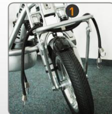
1 Ziehe die Spanngurte durch die Gepäckträger. 2 Setze den Korb in die Halterung ein. 3 Um den Korb zu stabilisieren benutze die Spanngurte.
