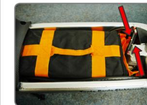
Nehme den Akku aus dem kleinen Karton und entferne ggf. das Transportsicherungsband von dem Stecker. Öffne mit dem Zündschlüssel das Akkufach und setze den Akku ein. Verbinde dann die beiden Stecker miteinander, die aus Sicherheitsgründen mit ein wenig Kraft zu stecken sind.
