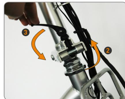
1 Schiebe vor dem Aufrichten den Bolzen zur Seite und richte den Lenker dann vollständig auf. Schiebe den Bolzen zurück, 2 klappe die Sicherungsschraube mit der Feder nach oben und 3 fixiere das Scharnier dann mit der schwarzen Sicherungsschnalle.
