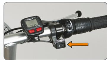
Im Auslieferungszustand fährt der Roller sanft an. Wenn du lieber etwas kräftiger losfahren willst, kannst du die Beschleunigung des Rollers erhöhen. Mit eingeschalteter Turbotaste (auf 1), ist die Beschleunigung höher, wenn die Turbotaste ausgeschaltet ist (auf 0) ist die Beschleunigung niedriger.
