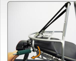
Löse die vier Schrauben vom Rahmen, achte darauf die Unterlegscheiben nicht zu verlieren. Setze den Gepäckträger auf den Roller und schraube ihn fest.
