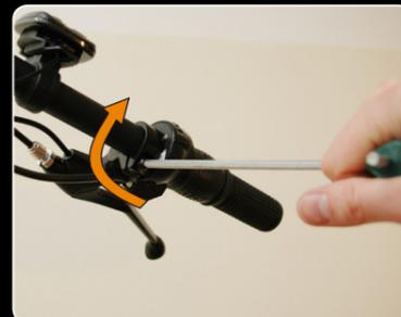
Um den Winkel einzustellen, löse die schwarze Schraube am Bremsgriff mit dem beiliegenden Werkzeug. Dann kannst du die Bremsen wie gewünscht verstellen. Achte darauf, die Schraube danach wieder sorgfältig festzuziehen.
