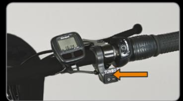
Im Auslieferungszustand fährt der Roller sanft an. Wenn du lieber etwas kräftiger losfahren willst, kannst du die Beschleunigung des Rollers erhöhen. Mit eingeschalteter Turbotaste (auf 1), ist die Beschleunigung höher, wenn die Turbotaste ausgeschaltet ist (auf 0) ist die Beschleunigung niedriger.
