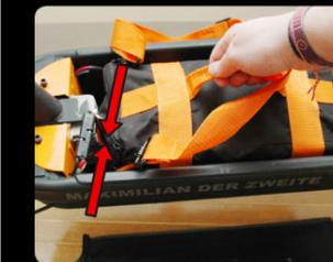
Nehme den Akku aus dem kleinen Karton und entferne ggf. das Transportsicherungsband von dem Stecker. Öffne mit dem Zündschlüssel das Akkufach und setze den Akku ein.
